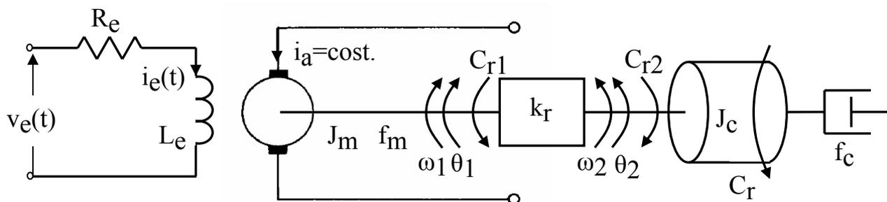
Nel seguito si vuole determinare un modello matematico del sistema in figura, costituito da un motore in corrente continua alimentato con corrente di armatura costante e pilotato dalla tensione  $v_e$  applicata al circuito di eccitazione.
