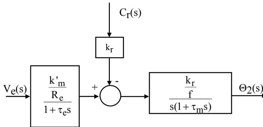
Infine, portando a valle la giunzione sommante si ottiene il diagramma a blocchi riportato di seguito, dopo aver posto:
