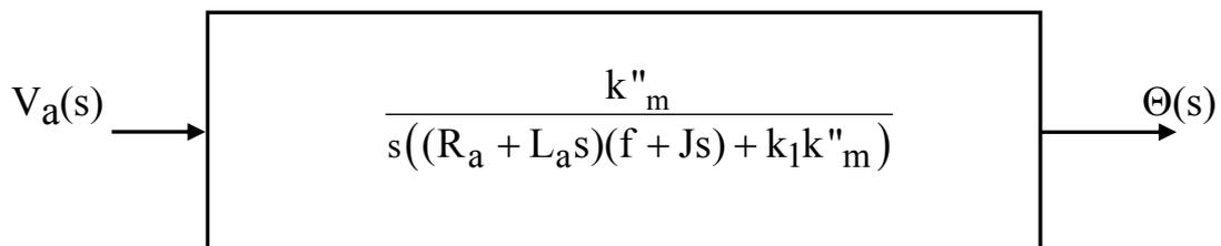
Normalmente l'induttanza del circuito di armatura è molto bassa e dunque trascurabile. Perciò, posto  $L_a=0$  nella precedente funzione di trasferimento, si ha:
