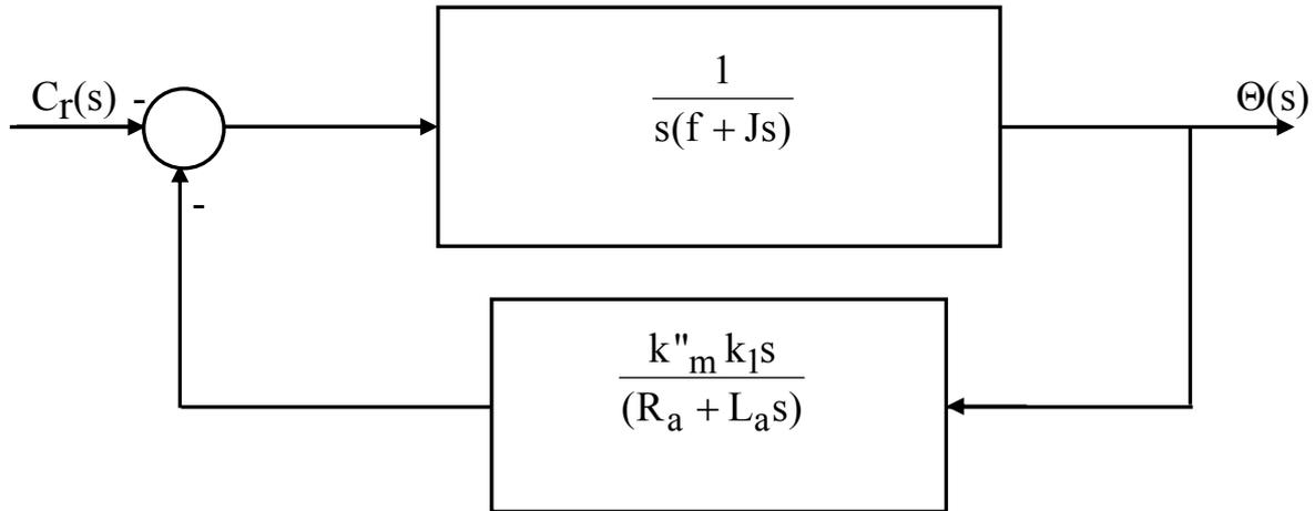
Da cui si ottiene la funzione di trasferimento relativa al solo disturbo.
