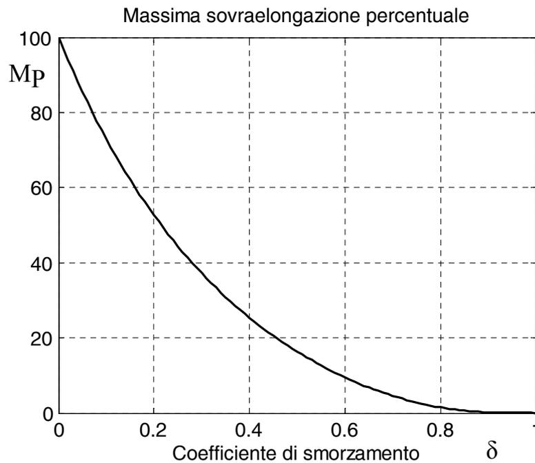
Valori tipici della massima sovraelongazione percentuale sono i valori dell'intervallo  $M_p \in [5\%, 40\%]$ , i quali si ottengono per valori del coefficiente di smorzamento  $\delta \in [0.28, 0.707]$ . In particolare valori notevoli della massima sovraelongazione percentuale si ottengono per  $\delta = 0.6$  ( $M_p \cong 10\%$ ) e per  $\delta = \frac{\sqrt{2}}{2} \cong 0.707$  ( $M_p \cong 5\%$ ).
