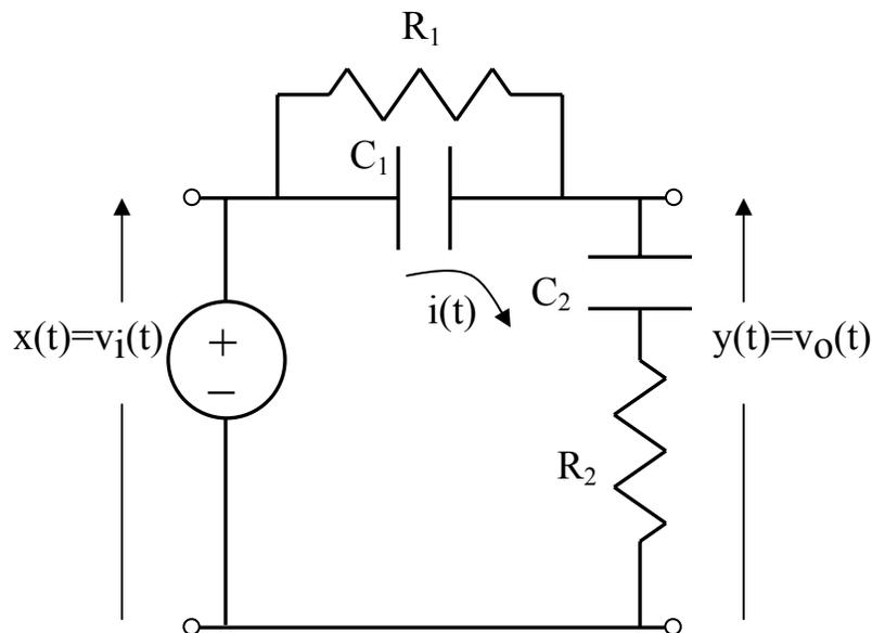
Applichiamo alla rete elettrica la legge di Kirchoff delle tensioni e quella delle correnti, nonché le proprietà caratteristiche delle resistenze e dei condensatori:
