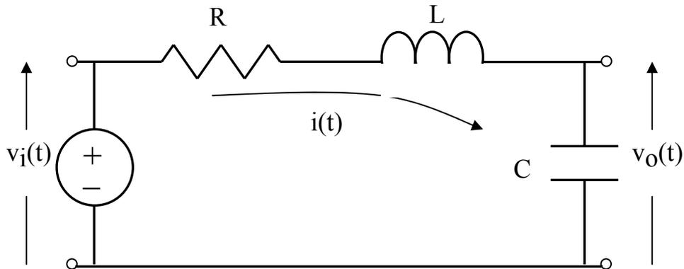
L'ingresso del sistema è la tensione ai capi del generatore  $v_i(t)$ , l'uscita del quadripolo è la tensione ai capi del condensatore  $v_o(t)$ .
