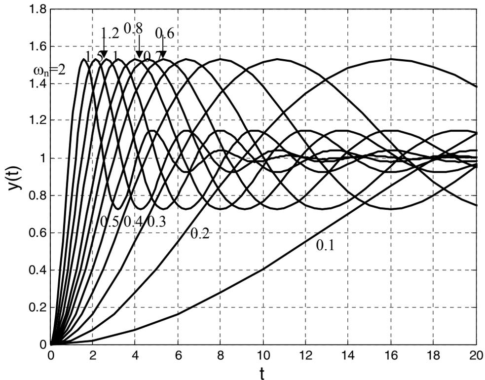
Consideriamo infine il caso in cui la funzione di trasferimento del sistema sia modificata mantenendo fisso il prodotto del coefficiente di smorzamento per la pulsazione naturale, ossia la parte reale dei poli. Ciò corrisponde a muovere i poli del sistema lungo una retta verticale di ascissa  $-\delta\omega_n$ .
