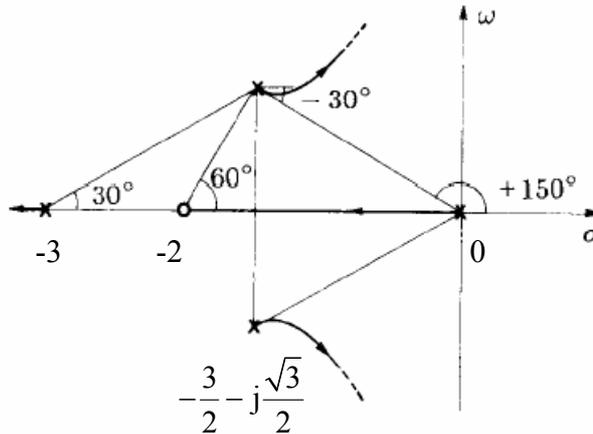
Il luogo comprende n=4 rami, che descrivono la posizione degli n=4 poli in anello chiuso al variare del guadagno K positivo. Essi partono dagli n=4 poli in anello aperto ( $s=0, s=-3, s = -\frac{3}{2} \pm j\frac{\sqrt{3}}{2}$ ) e giungono uno nell'unico zero al finito ( $s=-2$ ) del guadagno di anello e gli altri  $n-m=4-1=3$  in tre punti all'infinito secondo le direzioni asintotiche.
