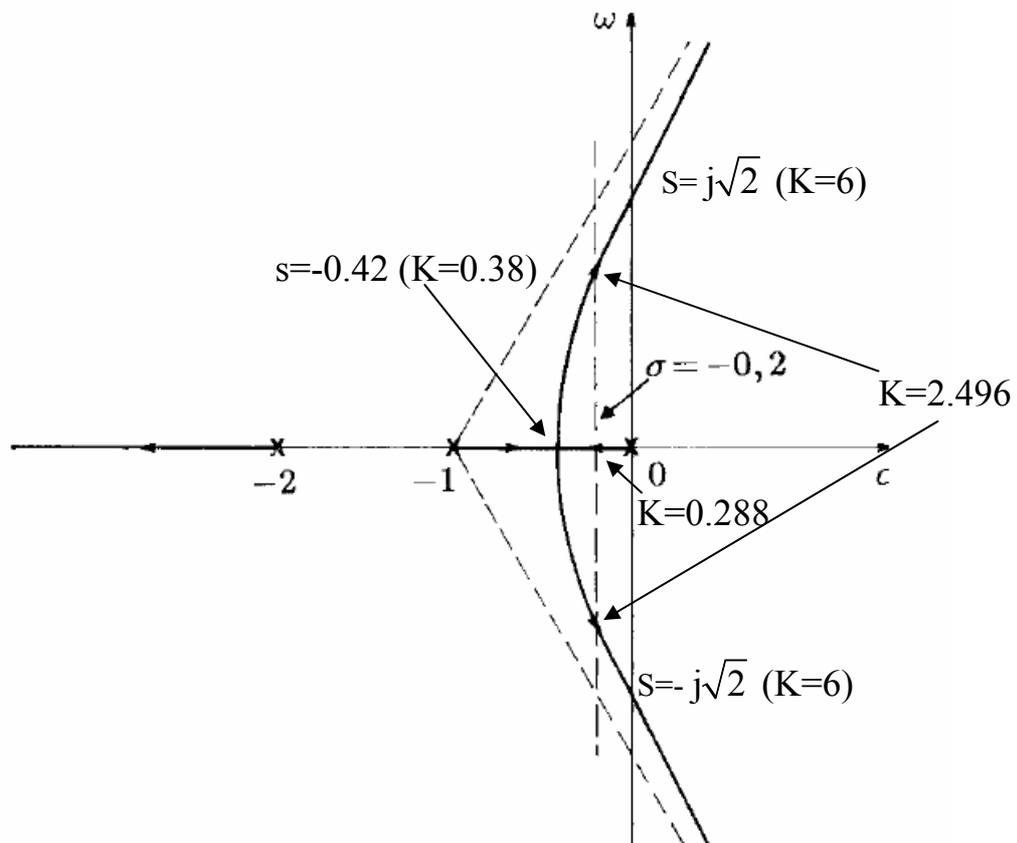
Osserviamo che il sistema in anello chiuso è condizionatamente stabile: all'aumentare del guadagno  $K$  il sistema diventa instabile, poiché due dei tre rami del luogo delle radici si spostano dal semipiano sinistro a quello destro nel piano di Gauss.
