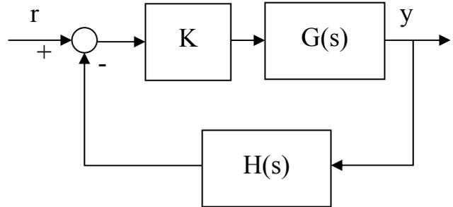
Il sistema in anello aperto ha due poli complessi e coniugati in  $s = -1 \pm j$  e uno zero in  $s = -2$ . Il luogo ha  $n=2$  rami, che partono dai poli in anello aperto  $s = -1 \pm j$  e giungono uno nello zero  $s = -2$  e l'altro nell'unico zero all'infinito secondo un asintoto. Questo ha direzione asintotica
