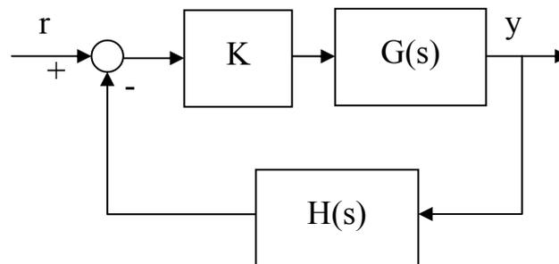
L'equazione caratteristica del sistema in retroazione è:
