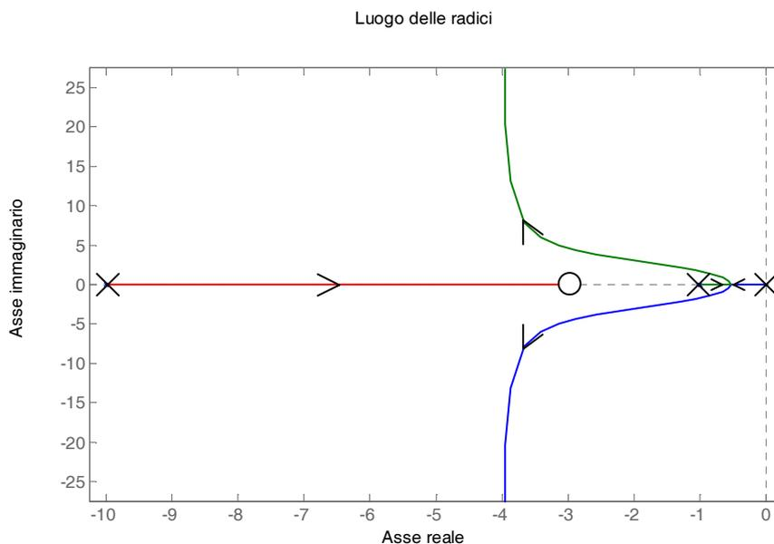
Il luogo ha evidentemente un punto doppio di emergenza sull'asse reale, che è un punto di massimo locale per il guadagno  $K$ . Tale radice doppia e il corrispondente valore del guadagno si possono calcolare con il metodo della taratura. Si ha
