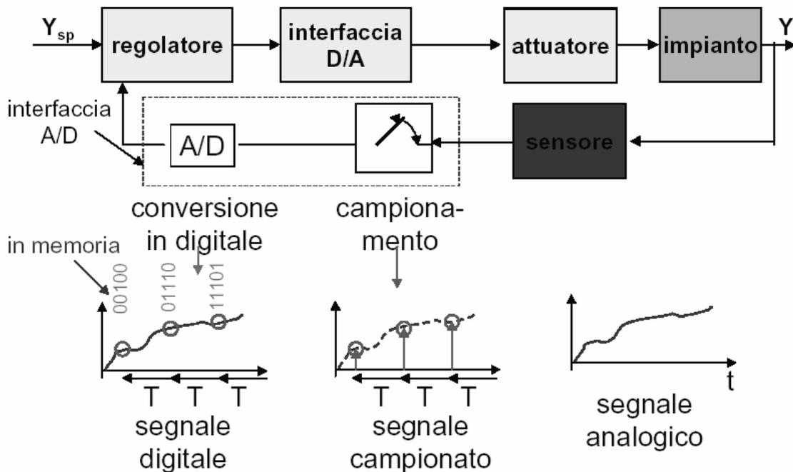
Il segnale misurato dal sensore è evidentemente *analogico e tempo continuo*. Esso viene quindi campionato ogni  $T$  intervalli di tempo da un dispositivo di
