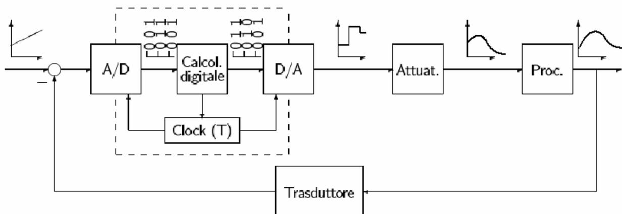
Come si vede nello schema a blocchi, il controllore analogico convenzionale è stato sostituito con un calcolatore che esegue un programma in cui è implementato l'algoritmo di controllo. Sono inoltre presenti un convertitore A/D e un convertitore D/A.
