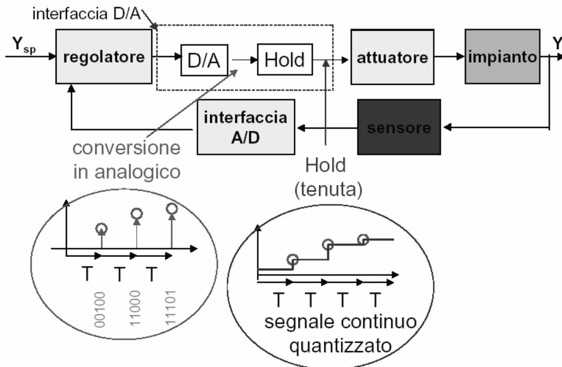
Il segnale fornito dall'elaboratore è *digitale*. Esso viene quindi convertito in segnale *a dati campionati* dal DAC e un dispositivo di tenuta (Hold) fornisce in uscita un segnale tempocontinuo quantizzato.
