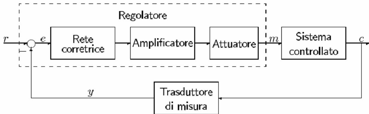
Il regolatore è costituito da una rete correttiva (o da un regolatore standard) seguito da un amplificatore, che riporta il segnale di controllo nel range di ingresso del plant, e da un organo attuatore. Tali componenti del controllore sono tutti analogici, dunque non sono necessari dispositivi di conversione che fungano da interfacce con il plant e il sensore.
