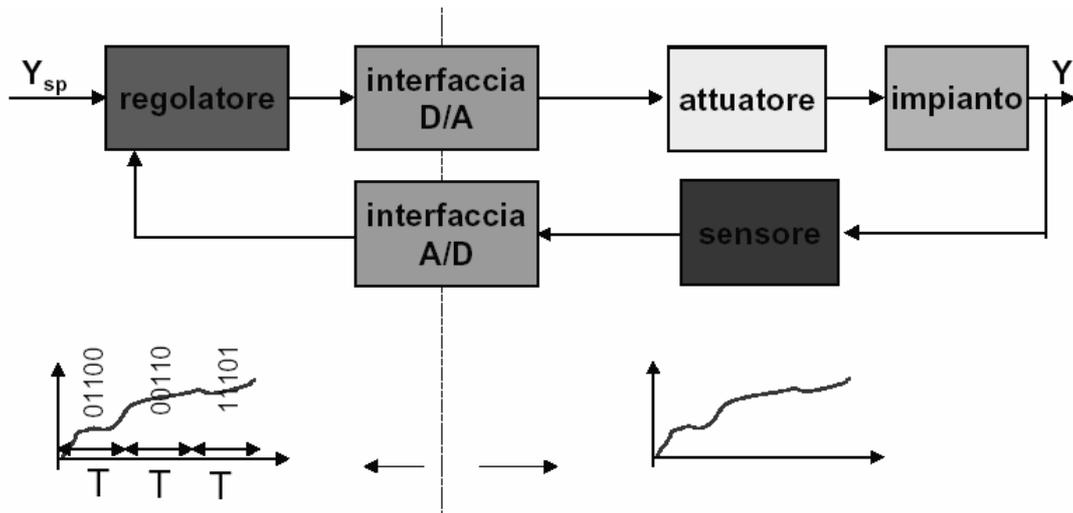
Come si vede dalla figura, è possibile effettuare una grossolana classificazione delle grandezze presenti in un anello di controllo digitale. In particolare, a valle dell'interfaccia digitale/analogica e prima di quella analogico/digitale si hanno segnali analogici a tempo continuo. Viceversa, nell'altra parte dell'anello le grandezze sono digitali.
