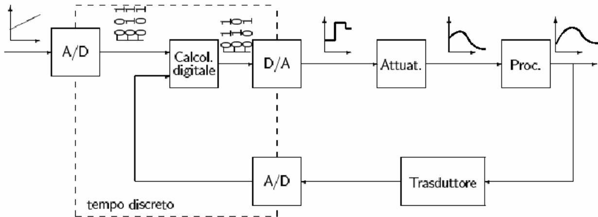
Quest'ultimo schema determina l'errore nell'ambito del programma che implementa la legge di controllo sull'elaboratore. In altri termini, mentre nel caso precedente è l'errore ad essere discretizzato, in questa configurazione del tutto equivalente sono il segnale di riferimento e quello retroazionato ad essere trasformati in grandezze digitali, e la generazione del segnale differenza (ossia dell'errore) avviene internamente al programma eseguito sul calcolatore digitale.
