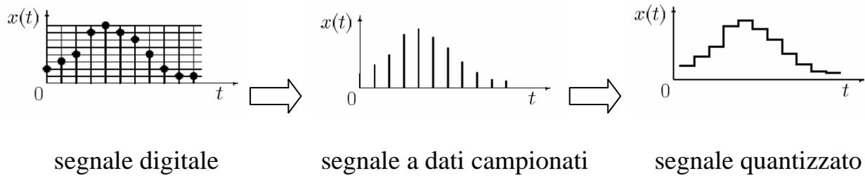
Il segnale quantizzato fornito dal dispositivo di tenuta viene quindi passato all'organo attuatore, che lo trasforma in un segnale analogico. Questo è il segnale di controllo analogico tempocontinuo che il plant riceve in ingresso.
