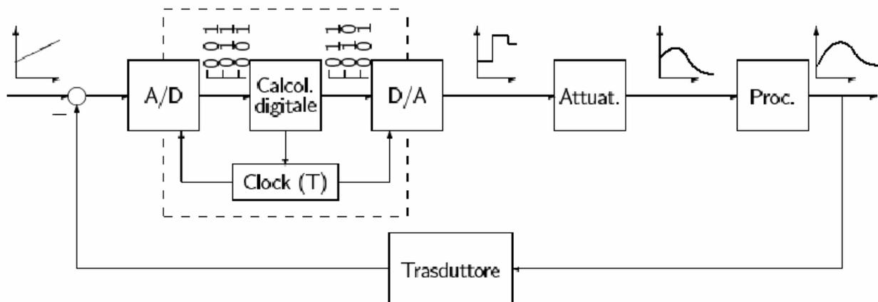
In definitiva, le grandezze elaborate dal regolatore digitale sono l'immagine a tempo discreto di quelle elaborate dal regolatore analogico (a tempo continuo). Le grandezze attuate (ossia i segnali in ingresso all'attuatore) sono il risultato dell'elaborazione a tempo discreto e vengono mantenute costanti per tutto l'intervallo di campionamento successivo all'intervallo di campionamento in cui vengono determinate dal dispositivo di tenuta.
