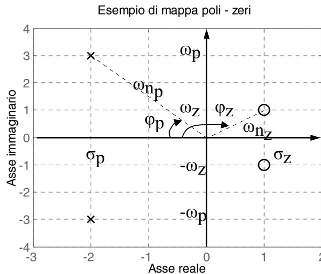
È utile rappresentare la funzione di trasferimento anche nella cosiddetta forma delle costanti di tempo. In particolare, dato uno zero (o un polo) reale, si definisce la sua costante di tempo come l'inverso dello zero (o del polo) cambiato di segno.
