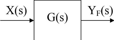
In definitiva, un sistema SISO lineare e tempoinvariante è modellato nel dominio del tempo da una equazione differenziale lineare a coefficienti costanti o, equivalentemente, è modellato nel dominio della frequenza complessa  $s$  dalla sua funzione di trasferimento.
