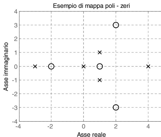
Si hanno  $m=4$  zeri in  $z_1=1$ ,  $z_2=-2$ ,  $z_3=2+3j$ ,  $z_4=2-3j$ , comprendenti  $\mu=0$  zeri nell'origine,  $m_1=2$  zeri reali e  $m_2=1$  coppia di zeri complessi e coniugati. Vi sono poi  $n=5$  poli in  $p_1=0$ ,  $p_2=4$ ,  $p_3=-3$ ,  $p_4=1+j$ ,  $p_5=1-j$ , comprendenti  $v=1$  poli nell'origine,  $n_1=2$  poli reali non nulli e  $n_2=1$  coppia di poli complessi e coniugati. Nella figura precedente è rappresentata la mappa poli-zeri del sistema.
