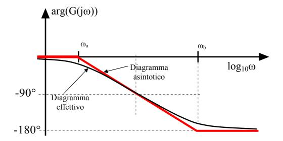
Infatti per determinare l'andamento del diagramma di Bode delle fasi asintotico nell'intorno della pulsazione naturale  $\omega_n$ , basta osservare che, al diminuire di  $\delta$ , le curve diventano più ripide nell'intorno della pulsazione naturale. Approssimiamo quindi il diagramma delle fasi con un segmento di pendenza pari alla tangente nel punto  $(\omega_n, -90^\circ)$ .
