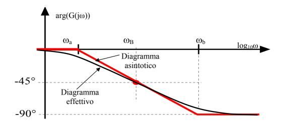
In particolare, conoscendo la pendenza del segmento passante per il punto  $(\omega_B, -45^\circ)$  possiamo individuare i punti  $\omega_a$  e  $\omega_b$  in cui il diagramma di Bode delle fasi è discontinuo.
