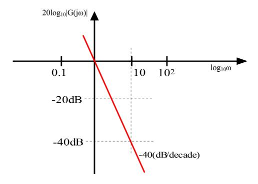
In generale, aumentando il numero  $\mu$  dei poli nell'origine la pendenza della retta passante per l'origine che rappresenta il diagramma delle ampiezze di  $G(j\omega) = (j\omega)^{-\mu}$  aumenta di 20 dB/decade per ogni aumento unitario di  $\mu$ .
