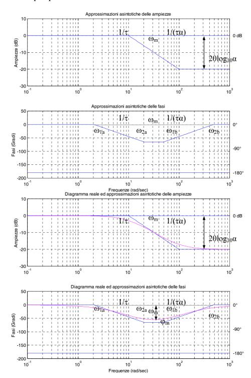
Le figure precedenti riportano sia il diagramma dei moduli che quello delle fasi asintotico e reale, tracciati con il software di calcolo Matlab per  $\alpha$ =0.1 e  $\tau$ =0.1.
