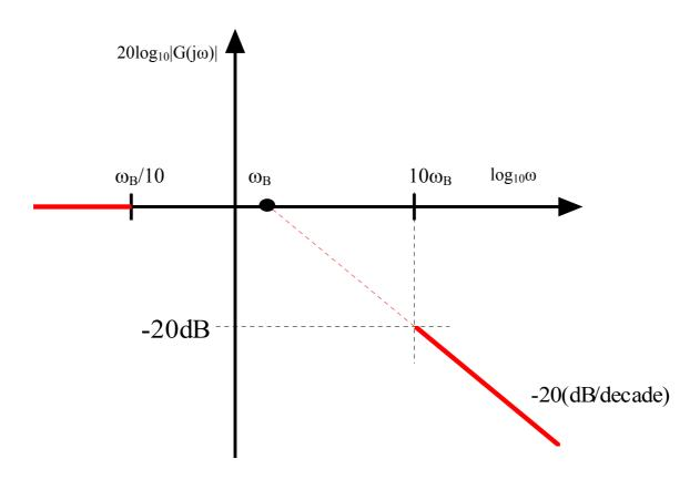
Per l'andamento del diagramma nell'intorno di  $\omega_B$ , ossia tra  $\omega_B/10$  e  $10\omega_B$ , si potrebbe calcolare  $|G(j\omega)|_{dB}$  in corrispondenza di tre o quattro punti nell'intervallo considerato e interpolare i valori ottenuti al fine di raccordare i due tratti estremi.
