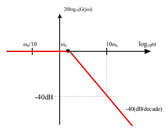
Si ottiene in tal modo un diagramma approssimato, che approssima bene il diagramma reale delle ampiezze. In particolare il modulo effettivo nella pulsazione di break vale
