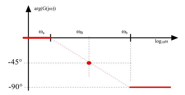
Per quanto riguarda l'andamento del diagramma nell'intorno della pulsazione di break  $\omega_B = \frac{1}{T}$ , approssimiamo il diagramma delle fasi con un segmento di pendenza pari alla tangente nel punto ( $\omega_B$ ,-45°).
