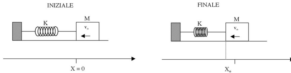
Sia dato un corpo di massa  $m = 10$  kg e velocità  $v_o = 10$  m/s che impatta sull'estremo libero di una molla di costante elastica  $k = 1000$  N/m in modo da provocarne la compressione. Si consideri dapprima liscia la superficie su cui scorre il corpo e successivamente scabra con un coefficiente di attrito dinamico pari a  $\mu_d = 0.5$ .
