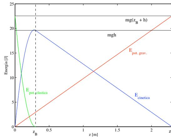
Figura 1: Andamento delle energie in gioco in funzione dalla posizione verticale  $z$
