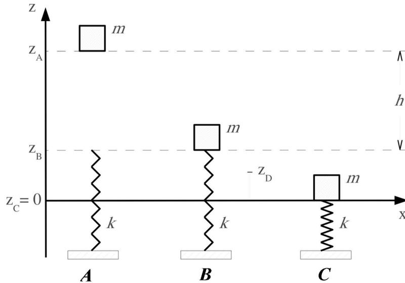
Un corpo di massa  $m$  è lasciato cadere da un'altezza  $h$  sull'estremo libero di una molla di costante elastica  $k$  in modo da provocarne la compressione. Determinare:
