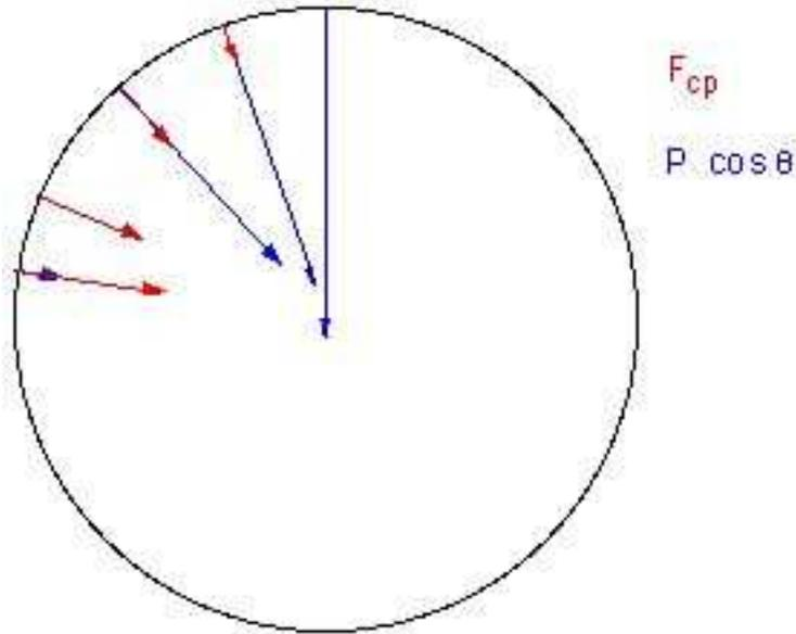
superficie sul corpo, la componente radiale della forza peso è maggiore della forza centripeta per tenere il corpo attaccato alla traiettoria circolare (la cui differenza è compensata dalla presenza della reazione vincolare), mentre la componente tangenziale fa accelerare il corpo. Lungo la direzione radiale,
