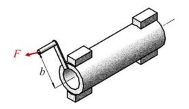
Un albero cavo in Fe320, è azionato da una manovella di estremità il cui braccio b=20cm; sul perno è applicata una forza F=1500N, trova il diametro esterno D ed il diametro interno d dell'albero, posto D=3/2d e considerando solo la torsione.
