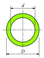
Essendo D=120mm e d=100mm, per un tubo in Fe 490. Calcola se con un  $M_f = 20 \cdot 10^6 \, Nmm$  siamo in condizioni di sicurezza.
