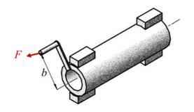
Un albero cavo in Fe320, è azionato da una manovella di estremità il cui braccio b=20cm; sul perno è applicata una forza F=1500N, trova il diametro esterno D ed il diametro interno d dell'albero, posto D=3/2d e considerando solo la torsione. (N.b. l'albero non è soggetto a fatica)
