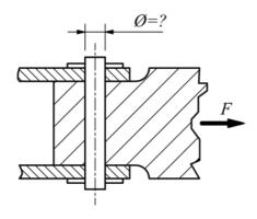
Calcola il diametro da assegnare al perno di sezione circolare in Fe590, sottoposto ad un forza di trazione F=65.000N.
