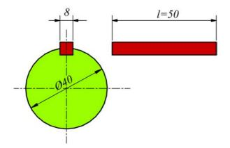
Un albero del diametro di 40mm porta una puleggia che trasmette una potenza di P=18kW alla velocità di 480g/m. Calcola lo sforzo di taglio che sollecita la linguetta che fissa la puleggia all'albero, se tale linguetta è larga 8mm e lunga 50mm.
