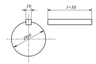
Un albero  $\phi 40$  trasmette un momento  $M = 3 \cdot 10^5 \ Nmm$  mediante una puleggia inchiavettata su di esso.
