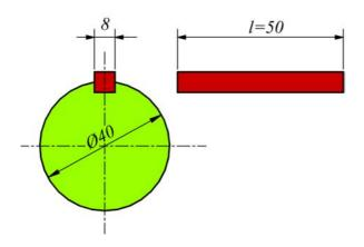
Un albero del diametro di 40mm porta una puleggia che trasmette una potenza di P=18kW alla velocità di 480g/m. Calcola lo sforzo di taglio che sollecita la linguetta che fissa la puleggia all'albero, se tale linguetta è larga 8mm e lunga 50mm.
