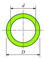
Essendo D=120mm e d=100mm, per un tubo in Fe 490. Calcola se con un  $M_f = 20 \cdot 10^6 \, Nmm$  siamo in condizioni di sicurezza.
