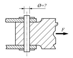
Calcola il diametro da assegnare al perno di sezione circolare in Fe590, sottoposto ad un forza di trazione F=65.000N.
