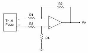
Anche in questo caso poniamo  $R_2=R_4$  e  $R_1=R_3$ . In caso di ingresso nullo, anche l'uscita è nulla, mentre in caso di ingresso massimo  $Vi_{MAX}=0,36$  V dobbiamo imporre l'uscita pari a 5 V. Si ha:
