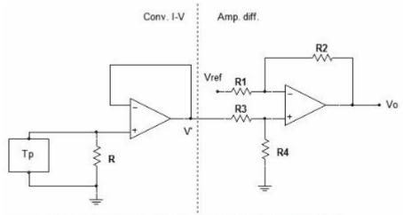
Scegliendo per  $R = 1 \text{ k}\Omega$  si ottengono i valori limite per V':
