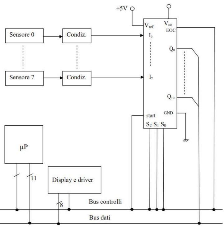
Ogni trasduttore produce una tensione di uscita con escursione massima di 1V ( $10 \text{ mV/°C} \times 100 \text{ °C}$ ) Non essendo data alcuna indicazione riguardo la tensione di uscita corrispondente ad un valore di riferimento della temperatura, possiamo ipotizzare che sia  $V_{out} = 0V$  per T=0 °C.
