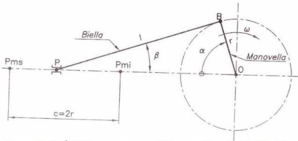
La portata media ( m³/s) di una pompa a stantuffo a semplice effetto è data dal prodotto della cilindrata del singolo cilindro che contiene il liquido aspirato ad ogni giro della manovella per:
