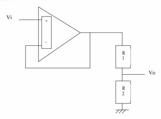
L'attenuatore può essere realizzato con componenti passivi ipotizzando per l'impedenza di ingresso del mux un valore sufficientemente elevato che non carichi la resistenza R2. In caso contrario verrà previsto un inseguitore anche in uscita.
