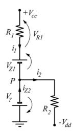
Ipotizziamo ora che  $D_1$  sia polarizzato inversamente e  $D_2$  direttamente. come rappresentato dove il diodo  $D_2$  lavora come un normale diodo a giunzione con tensione di soglia  $V\gamma=0,7$  V
