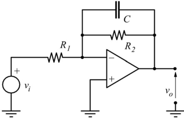
Si vuole realizzare un filtro passa-basso del 1° ordine con rapporto di amplificazione  $K=20$  e frequenza di taglio  $f_T=10\text{kHz}$  usando la resistenza di reazione  $R_2=10\text{k}\Omega$ . Dimensionare i componenti.
