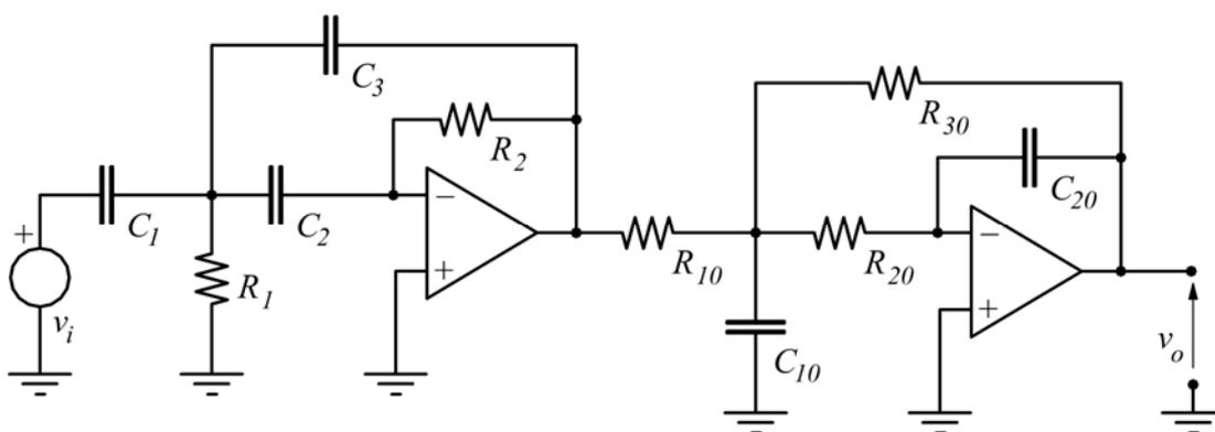
Progettare un filtro passa-banda con pulsazioni di taglio  $\omega_i=10^2\text{r/s}$  e  $\omega_s=10^5\text{r/s}$  con guadagno a centro banda di 40dB, usando due filtri (passa-basso e passa-alto) a reazione multipla, disposti in cascata.
