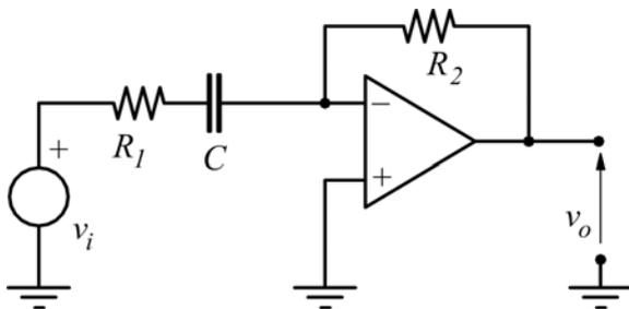
Progettare un filtro passa-alto del 1° ordine con rapporto di amplificazione  $K=10$  e frequenza di taglio  $f_T=20\text{kHz}$  usando la resistenza di reazione  $R_2=10\text{k}\Omega$ ,
