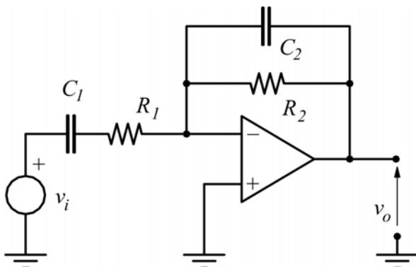
Progettare un filtro passa-banda del 1° ordine con rapporto di amplificazione  $K=5$  e frequenze di taglio  $f_i=100\text{Hz}$  ed  $f_s=100\text{kHz}$  usando la resistenza di reazione  $R_2=10\text{k}\Omega$ .
