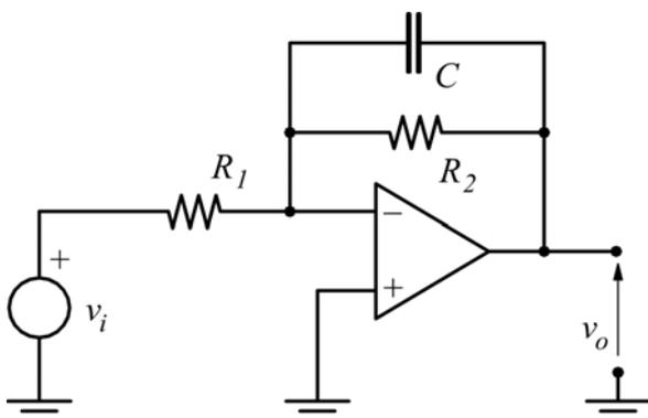
Progettare un filtro passa-basso del primo ordine con  $f_T=10\text{kHz}$  ed  $R_2=8\text{k}\Omega$  con amplificazione in banda piatta  $|K|=5$ . Il segnale di ingresso vale:
