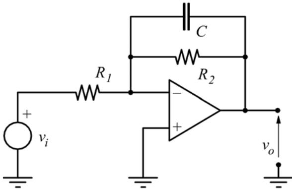
Progettare un filtro passa-basso del primo ordine con frequenza di taglio  $f_T=10\text{kHz}$  e resistenza di reazione  $R_2=8\text{k}\Omega$  con amplificazione in banda piatta  $|K|=5$ . Il segnale di ingresso vale:
