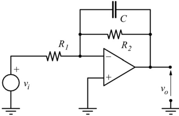
Si vuole realizzare un filtro passa-basso del 1° ordine con rapporto di amplificazione  $K=20$  e frequenza di taglio  $f_T=10\text{kHz}$  usando la resistenza di reazione  $R_2=10\text{k}\Omega$ .
