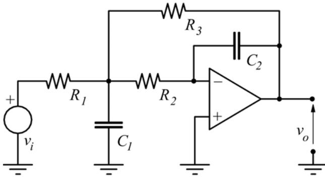
Progettare un filtro passa-bassi di Butterworth con circuito a retroazione multipla con frequenza di taglio  $f_T=1\text{kHz}$  ed amplificazione in banda  $|K|=12$  con il condensatore  $C_2=1\text{ nF}$ .
