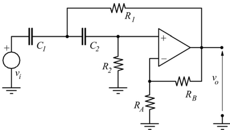
Nel filtro passa-alto VCVS si ha  $R_1=R_2=R=10\text{k}\Omega$ ;  $R_A=22\text{k}\Omega$ ;  $C_1=C_2=C=10\text{nF}$ .
