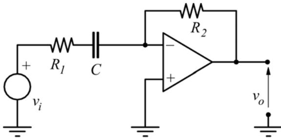
Progettare un filtro passa-alto del I° ordine con rapporto di amplificazione  $K=10$  e frequenza di taglio  $f_T=20\text{kHz}$  usando la resistenza di reazione  $R_2=10\text{k}\Omega$ ,
